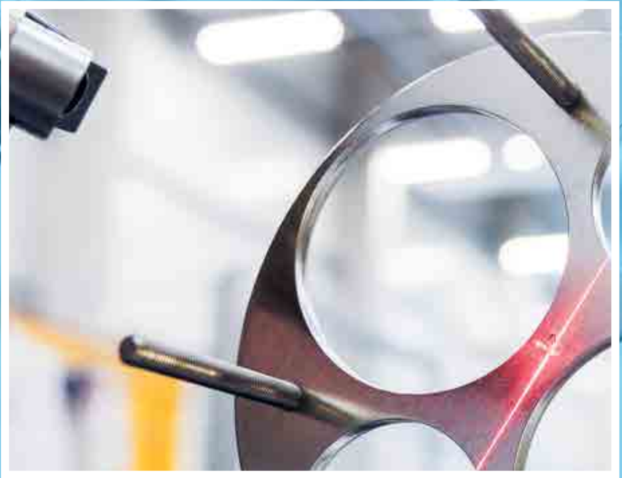
Controllo qualità finale sull'anello di supporto
